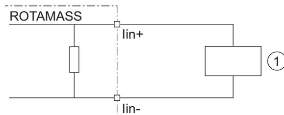
Рис. 45. Подсоединение внешнего устройства с активным токовым выходом
