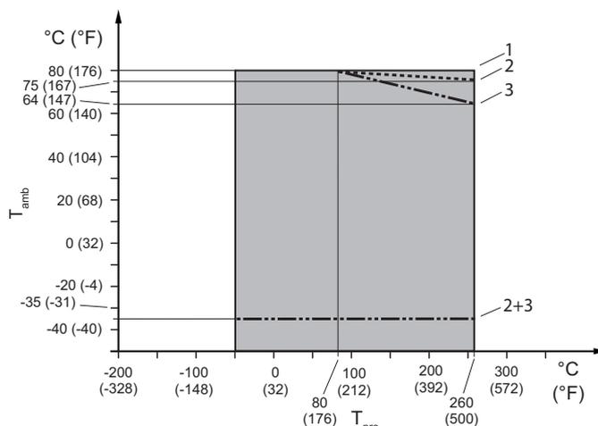
Рис. 24. Допустимая температура рабочей среды и окружающей среды
