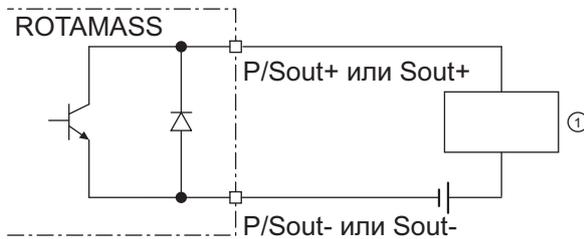
Рис. 41. Соединение пассивного выхода состояния P/Sout или Sout
