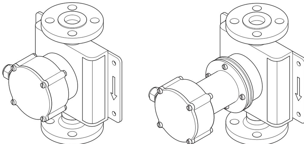
Рис. 25. Датчик со стандартным и удлиненным соединением
