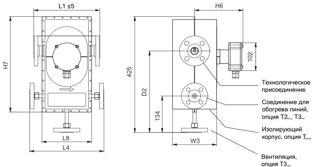
Рис. 27. Размеры в мм: версия с изолирующим корпусом
