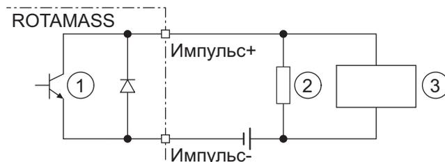
Рис. 48. Соединение пассивного импульсного выхода с электронным счетчиком
