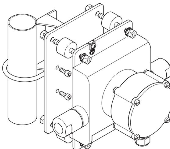
Рис. 53. Опциональный фиксатор PD для датчика Rotamass Nano
