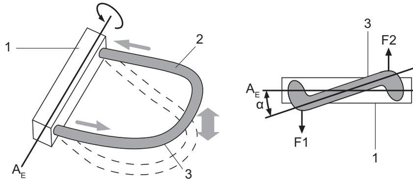
Рис. 2. Силы Кориолиса и деформация измерительных трубок
