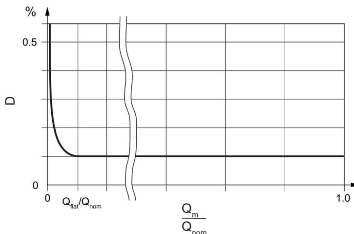
Рис. 9. Схема зависимости максимального отклонения от массового расхода
