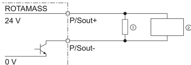
Рис. 34. Соединение активного импульсного выхода P/Sout
