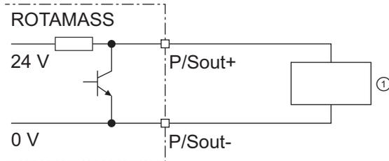
Рис. 40. Активный выход состояния P/Sout с внутренним нагрузочным резистором
