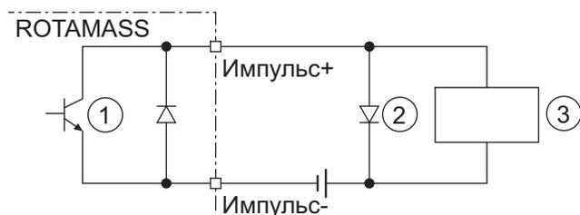
Рис. 49. Соединение пассивного импульсного выхода с электромеханическим счетчиком
