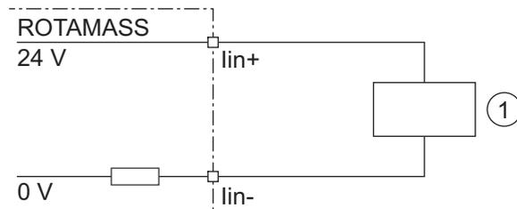
Рис. 44. Подсоединение внешнего устройства с пассивным токовым выходом
