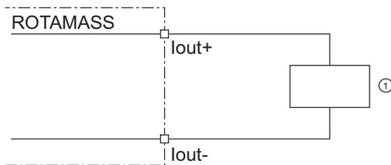
Рис. 31. Соединение активного токового выхода *I<sub>out</sub>* HART
