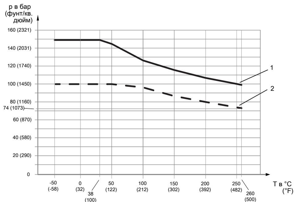
Рис. 15. Допустимое давление технологического процесса в зависимости от температуры в месте технологического присоединения
