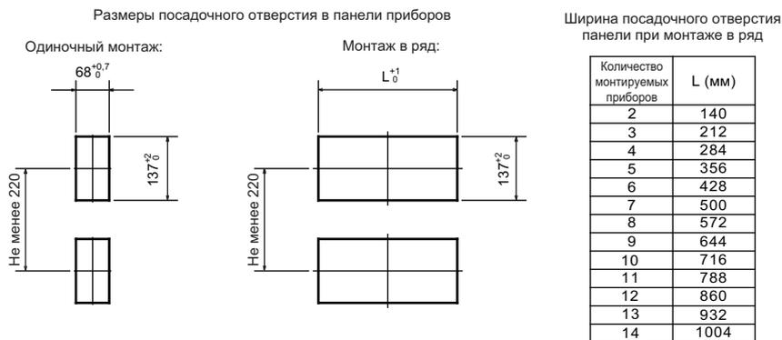
Замечание 1: Если табличка и т.п. устанавливается в пределах 60 мм около прибора, высота таблички и т.п. должна быть 30 мм или меньше от поверхности приборной панели.
