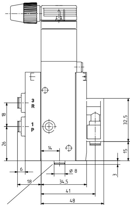
Raccordement : de vanne à 3 voies en fonction C, raccord rapide, orifice d'utilisation 4 vers le bas
