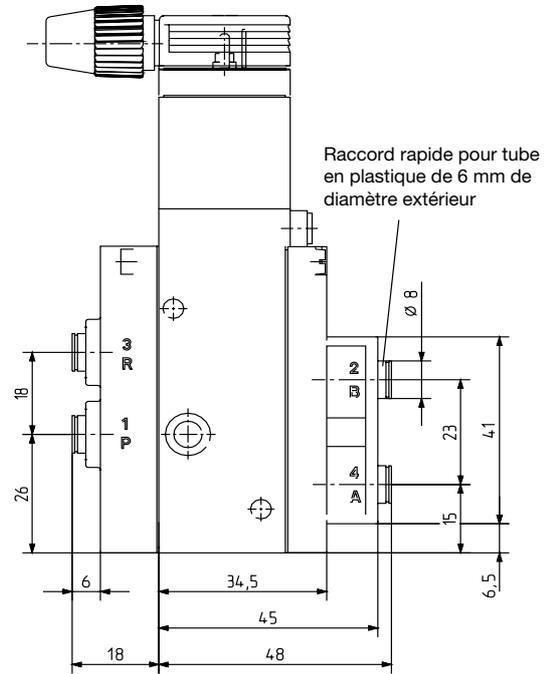
Raccordement : raccord rapide pour tube en plastique de 6 mm de diamètre, orifices d'utilisation 2 et 4 vers le bas
