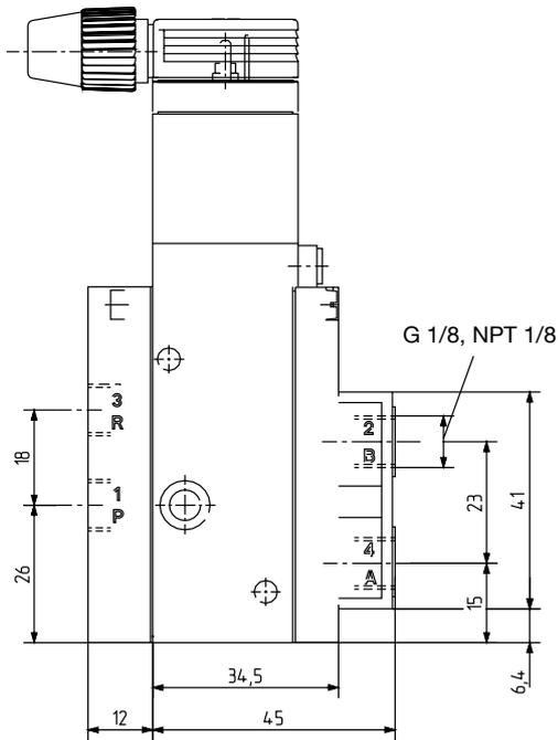
Raccordement : raccord rapide pour tube en plastique de  $\varnothing 6$  mm
