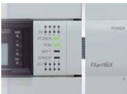
К базовому модулю FX3U можно подключить как новые модули FX3U, так и стандартные расширительные модули серий FXON и FX2N.
