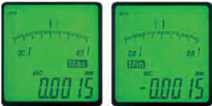
Измерение макс./мин. значения или биения (амплитуды)
