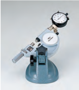
Пример применения: с индикатором часового типа
