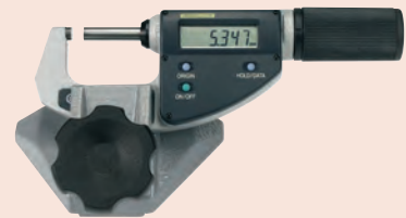
293-666 со стойкой 156-105-10 (дополнительные принадлежности)
